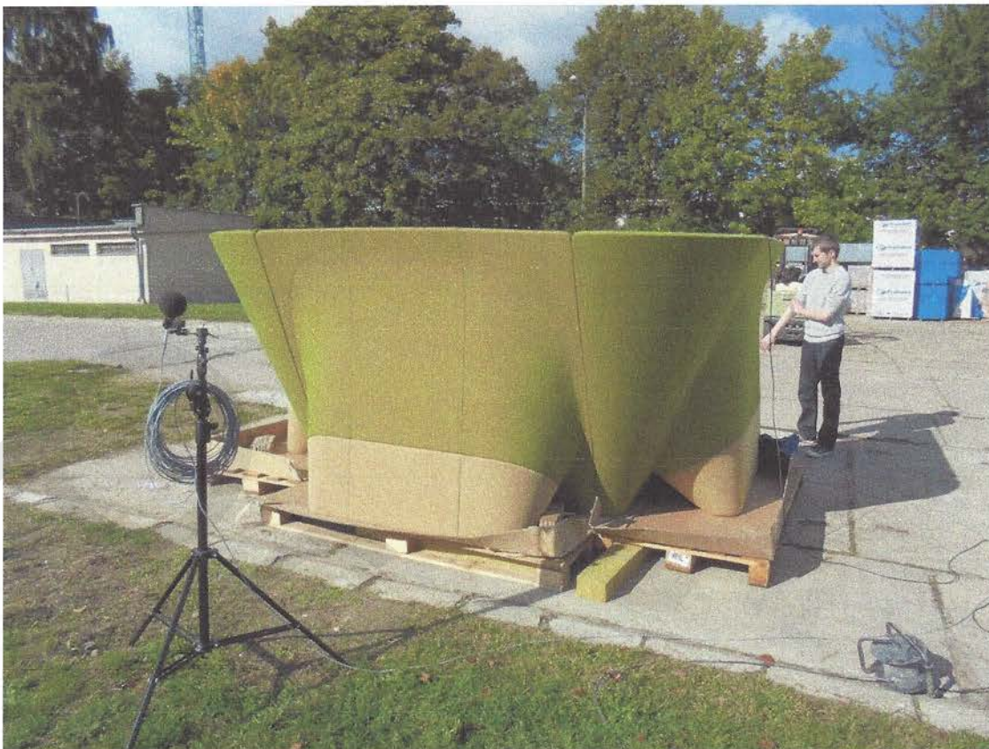
Rys. 4. Widok badanego zestawu – pozycja mikrofonu odbiorczego dla pozycji nr 1 źródła.
