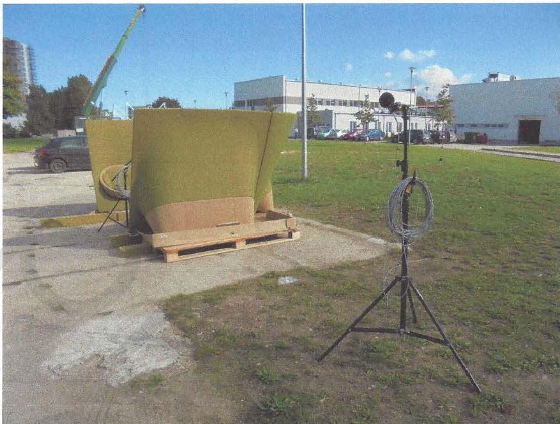
Rys. 6. Widok badanego zestawu – pozycja mikrofonu odbiorczego dla pozycji nr 2 źródła.
